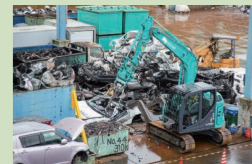
小型ニブラで自動車から再生資源を取り出している様子
